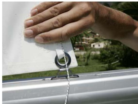
3. Die Unterliekstreckerleine (rot) wird von Backbord nach Steuerbord durch das Auge am Segel geführt und mit einem einfachen Knoten am Schlitz des Baumendes beklemmt.
