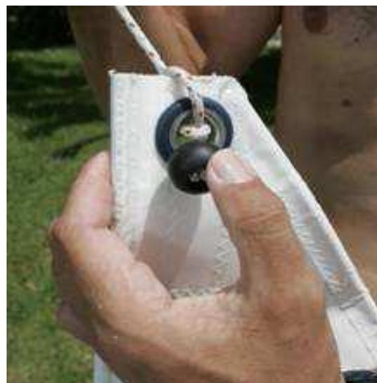
6. Führen Sie den Kopf des Segels in die Mastnut (Führung auf der Rückseite des Mastes) ein. Achten Sie darauf, dass Sie dies von der Backbordseite machen, damit das Segel frei vom Gnavbaum gesetzt werden kann. Achten Sie auch darauf, dass das Großfall frei läuft.
