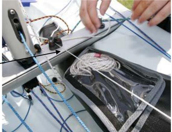
10. Nachdem das Fockfall auf Spannung gesetzt wurde, können Sie die Gnavwanten nachspannen. **Es ist unabdingbar, dass der Mast** (vor dem Setzen des Großsegels) **gerade ist**. Achten Sie beim Einstellen der Gnavwanten unbedingt darauf.
