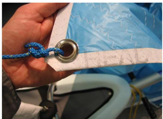
11. Nehmen Sie nun das Ende des Falls, das sie soeben durch die Gennakersocke geführt haben und führen Sie es zuerst durch den aufgenähten Ring im Segel und befestigen es dann an den Gurtschlaufen (ein wenig weiter oben im Segel) mit Hilfe eines Palsteks.
