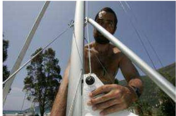
7. Setzen Sie nun das Großsegel. Dafür könnten 2 Personen benötigt werden, da es hilfreich ist, wenn eine Person das Fall zieht, das auf der Backbordseite am Mast austritt, und eine weitere Person hilft das Segel am Mast einzuführen. Dadurch können Schäden am Vorliekstreifen des Segels verhindert werden.
