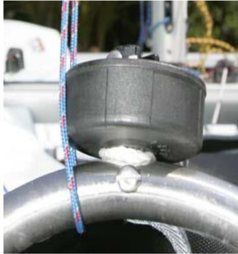
2. Rollen Sie nun die Fock aus und befestigen Sie den Hals der Fock (vordere Ecke) mit dem Bolzen aus der Trommel der Rollfockanlage. Kleben Sie anschließend die Splintringe und Bolzen ab.
