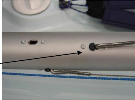
4. Befestigen Sie die Trapezdrähte (separat erhältlich) in die dafür vorgesehenen Löcher oberhalb der Wanten und dichten Sie sie mit den verbleibenden Gummistopfen ab.
