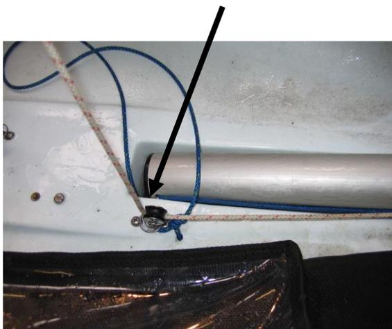
4. Führen Sie das untere Ende des Falls durch den Umlenckblock unterhalb der Gennakersocke im Bug des Bootes.
