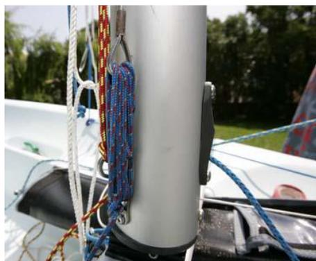
9. Rollen Sie die Fock auf, indem Sie an der Leine auf der Steuerbordseite des Mastbalkens ziehen und die Fockschoten lösen.
