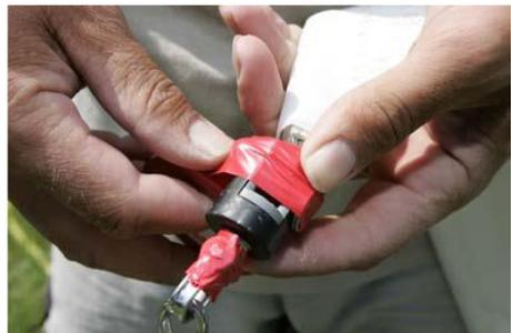
4. Ziehen Sie die Fock hoch, indem Sie die weiße Leine auf der Rückseite des Mastes durchholen. Beim Hochziehen kann es zu einem kurzen Widerstand kommen, wenn das Drahtauge durch die Mastöffnung gezogen wird. Hängen Sie die Fockfalltalje mit dem Haken nun in das Drahtauge des Falls ein.
