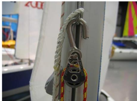
5. Stellen Sie die Spannung mit Hilfe der Talje so ein, dass der Draht im Vorliek der Fock stramm sitzt. Verstauen Sie den Rest der Leine in der Fallentasche, die auf der Gennakersocke angebracht ist.
