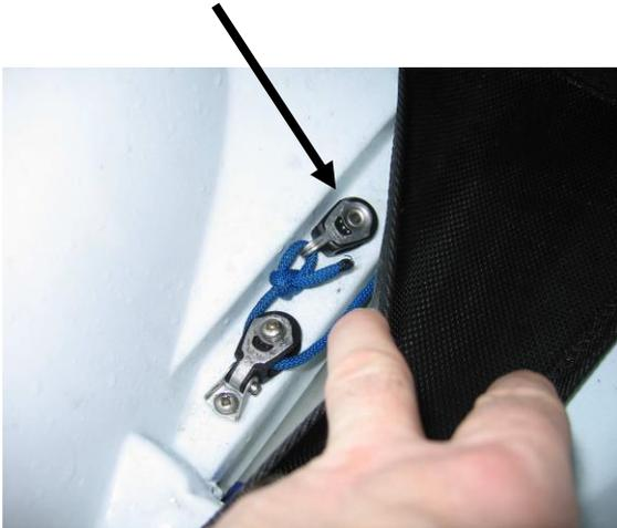
5. Führen Sie das Fall zurück zum Mast und durch die Klemme nahe des Mastfußes und den dahinter liegenden Block.
