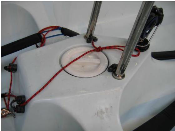
2. Auf der Mittelkonsole unter dem Bügel für die Großschot. Dies ist ein wasserdichter Stauraum für Mobiltelefone, Schlüssel, Portemonnaies oder ähnliches und ist nicht Teil des Auftriebskörpers.
