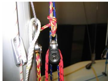
5. Befestigen Sie die Gnavstange mit dem oberen Ende am dafür vorgesehen Beschlag am Mast. Achten Sie darauf, dass der abgeschrägte Teil des Verbindungsstückes nach oben zeigt. Der Klappmechanismus des Bolzens soll auch hier nach unten zeigen und anschließend wieder gesichert werden.
