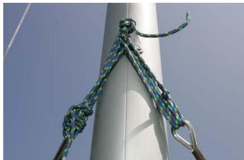
6. Stecken Sie die am Boot befestigte Schlaufe der Gummileine durch das kleine Auge unter der Rolle am Trapezdraht (Trapezkit ist eine optionale Ausrüstung).
