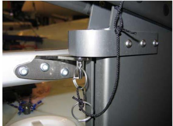
Als zusätzliche Sicherung ist eine Leine zu empfehlen. Dem Boot liegen zwei verschieden lange Leinen in der kleinen Tasche im Cockpit bei.
